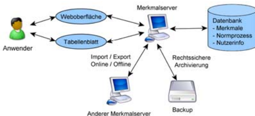
Bild 5: Einbindung des Audit-Trail in Merkmalsserver
